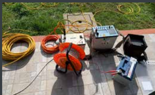
Attrezzatura utilizzata: georesistivimetro SYSCAL Pro Switch con 96 elettrodi e 10 canali
